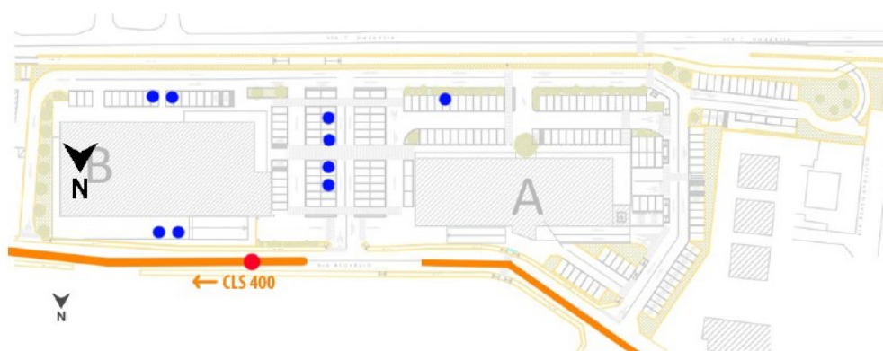
Figura 15 – Scarico acque reflue (in rosso), meteoriche (in blu) e rete fognaria pubblica esistente (in arancione)
