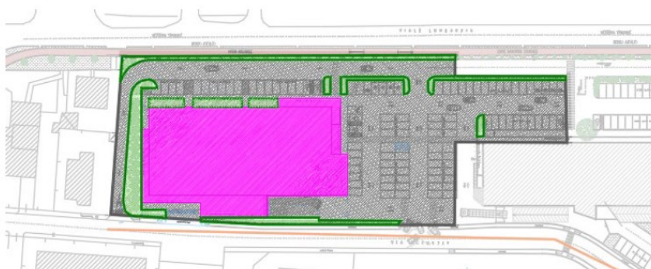
Figura 16 – Suddivisione area scolante in aree verdi, coperture (viola), asfaltate (grigio) – Stato di Progetto
