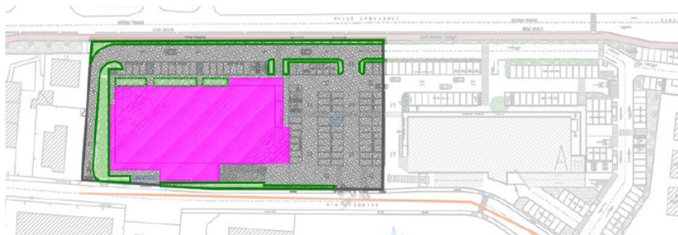
Figura 21 – Suddivisione aree scolanti di pertinenza dei nuovi pozzi perdenti – Stato di Progetto
